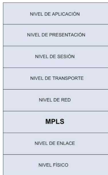
Figura 8: Situación de MPLS en el modelo de referencia OSI
