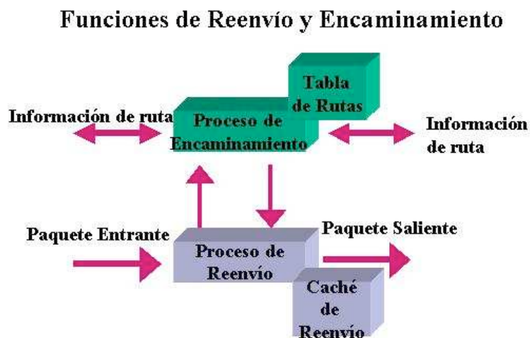
Figura 2: Esquema de las funciones de reenvío y encaminamiento
